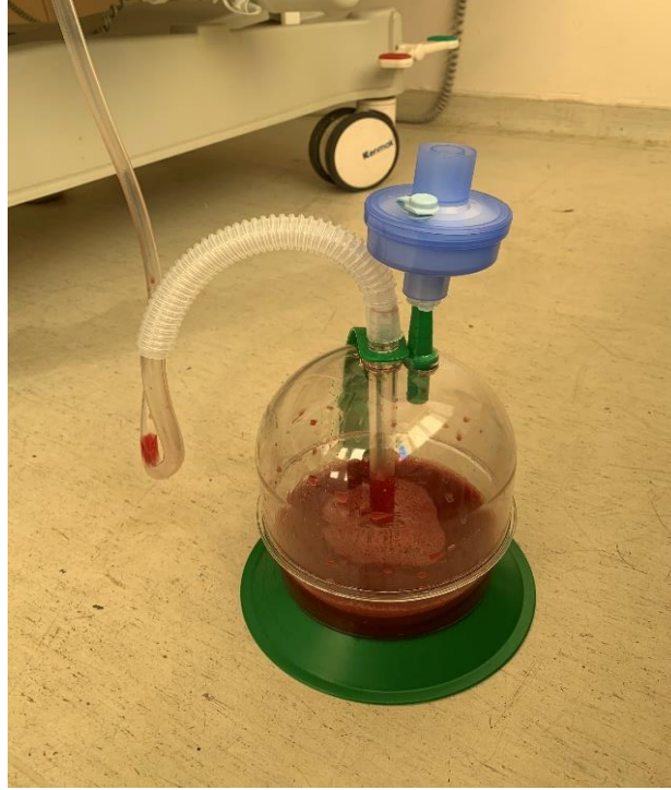
Resim 10.2: HEPA filtrenin tahliye deliğine yerleştirilmesi
