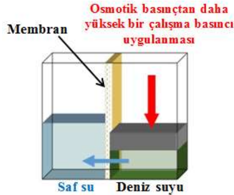
Şekil 7. Deniz suyu desalinasyonu konusunda ters osmozun çalışma prensibi [5]
