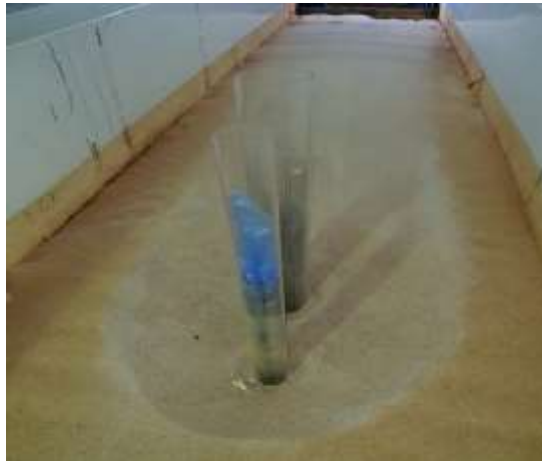
Şekil 8. Köprü ayağı etrafında oluşan oyulma
