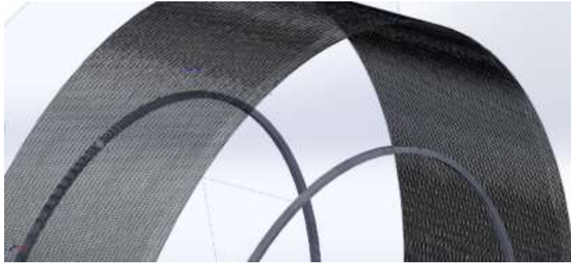
Şekil 4. Tekerlekte gövde ve topukta kullanılan teller
