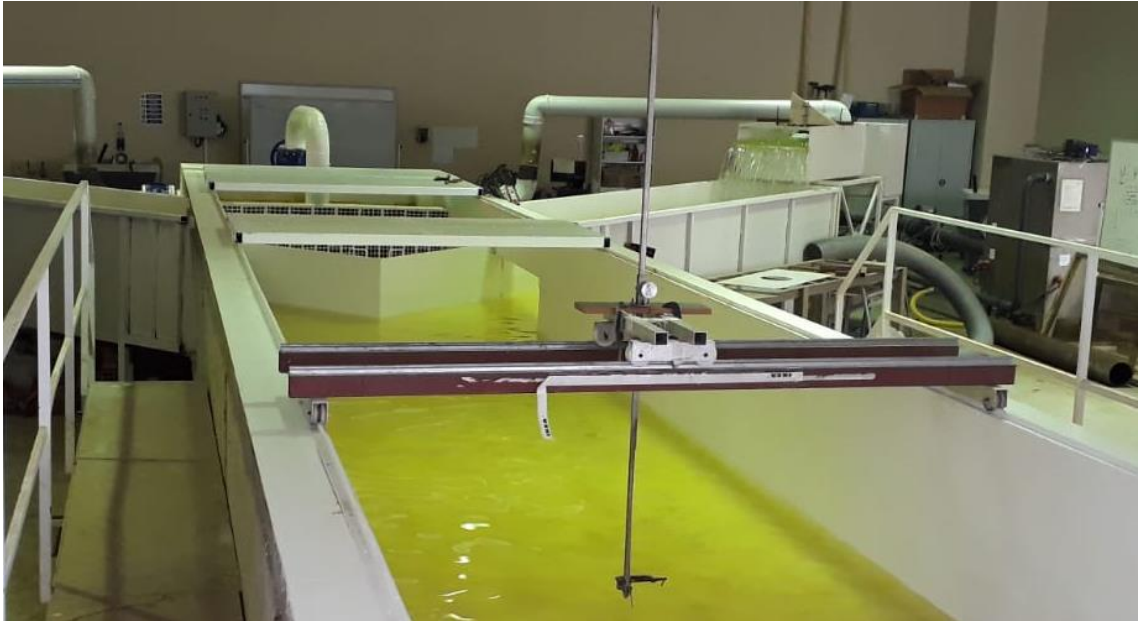
Şekil 8. Ana kanal üzerinde limnimetre
