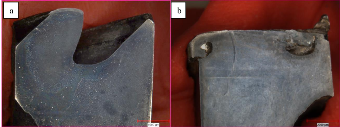
Şekil 5. Hasarsız (a) ve hasarlı (b) numune kesitlerinin stereo mikroskop görüntüleri
