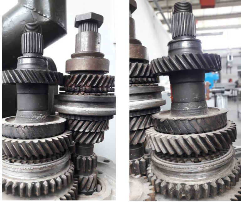
Şekil 1. Hasara uğrayan dişli mekanizması
